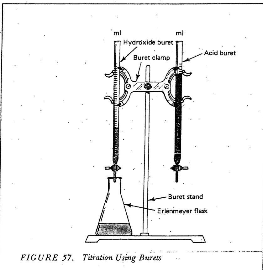
FIGURE 57. *Titration Using Burets*
